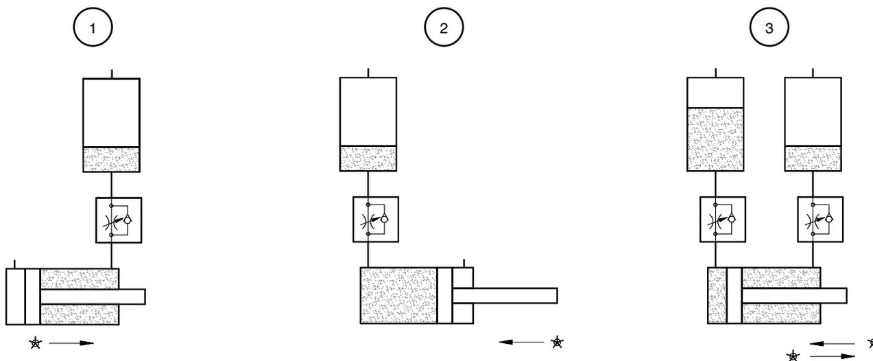
\* verso di regolazione velocità stelo - control direction of rod speed
